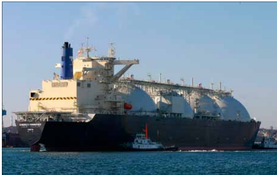
Kawasaki's 145,000 cubic metre LNG carrier, Energy Frontier
